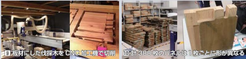
9 板材にした伐採木をCNC加工機で切削 10 計388枚のパネルは1枚ごとに形が異なる
