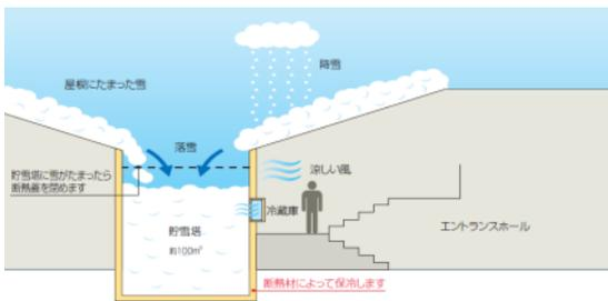
図-3 自然落雪式貯雪塔概念図
