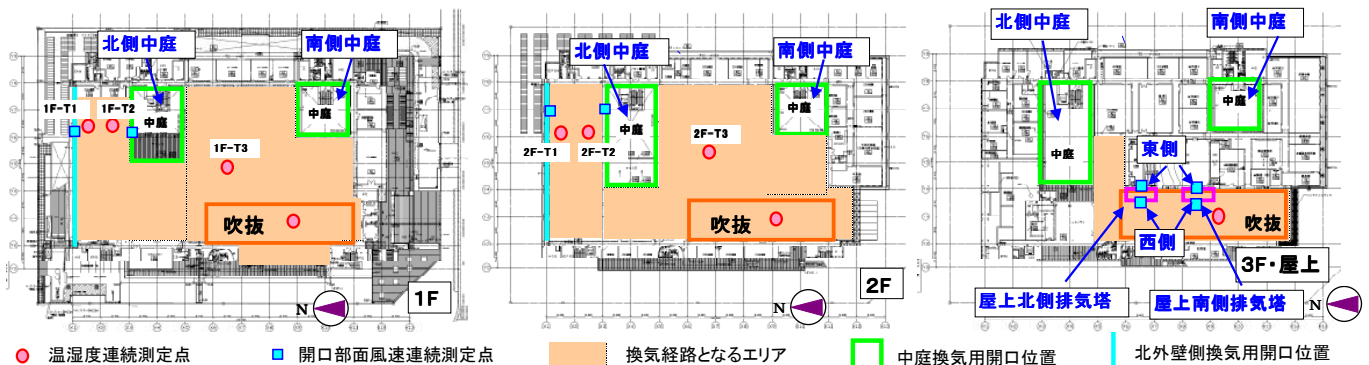
図1 開放する開口部の位置と主な測定点
