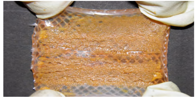
写真5 中空糸膜実験で形成したバイオフィルム (実浴槽水)
