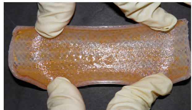
写真6 紫外線併用実験で形成したバイオフィルム (実浴槽水)
