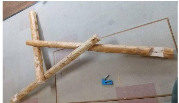
図9 製作したレシプロカル構造ユニット
