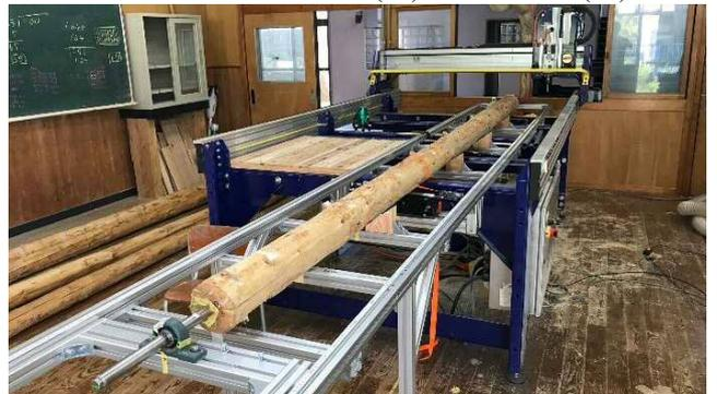
図8 丸太梁の加工状況
