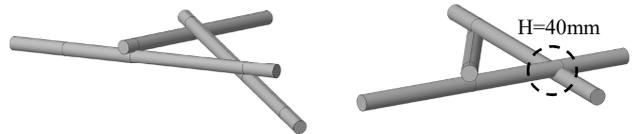
図7 材芯間距離全て80mm(左)と一部40mm(右)の例
