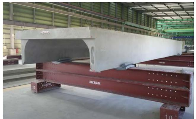
写真-9 脱型後の製品状況
