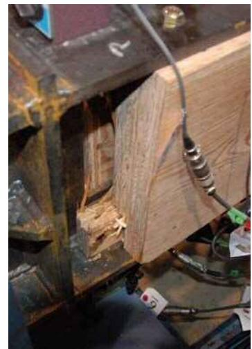
図24 ブロックせん断破壊状況
