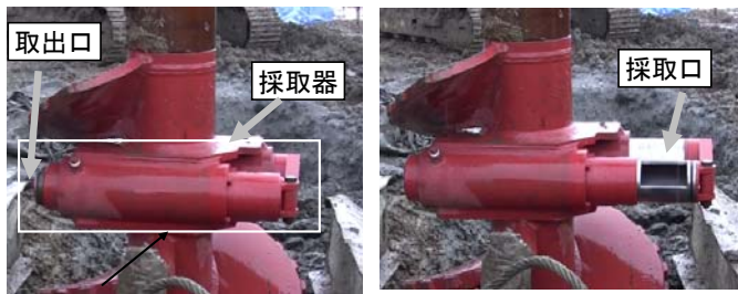
(a)採取口の閉口時 (b) 採取口の開口時 写真1 採取ビット
