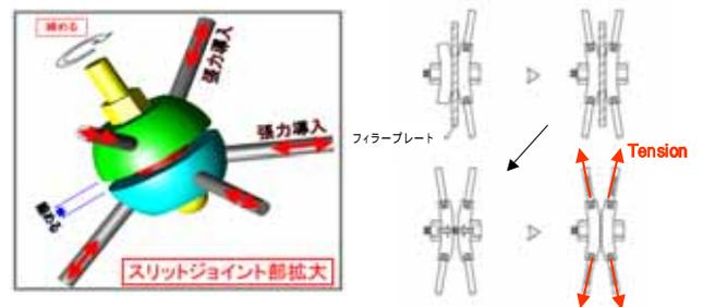
図-6 張力導入機構(スリットジョイント)
